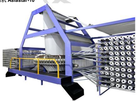
Asiastar-10 十梭圆织机折径范围 1800~2300mm 最高转速可达 80 转/分钟。 此机型是公司专门为集装袋、土工布生产而设计的,适合集装袋行业、土工布行业。 双层跳杆结构多层经导辊,上下送经系统,内压式收卷、大直径纬纱,纬纱张力调节装置等特 殊设计为用户生产高质量的集装袋布提供保证。
