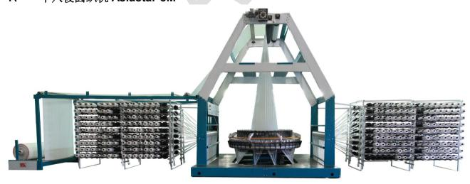
Asiastar-8M 中八梭圆织机折径范围 1250~1550mm 最高转速可达 120 转/分钟。 此机型是公司专门为 PE 蓬布生产而设计的,适合蓬布行业、灯箱布行业 机器为适应 PE 扁丝有编织特别设计了送经、跳杆及纬纱张力补偿装置等,极大满足 PE 编织布的生产加工。
