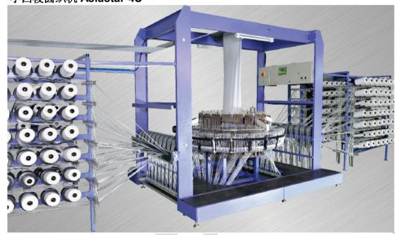
小四梭圆织机折径范围 200~500mm 最高转速可达 220 转/分钟。 此机型是专门为超小型编织袋的生产而设计,适合行业:粮食、鉰料等 此机型配备特殊送经装置的经纱张力补偿装置,确保透明袋的生产,生产 300mm 左右折径的 袋布产量超过小六梭圆织机。
