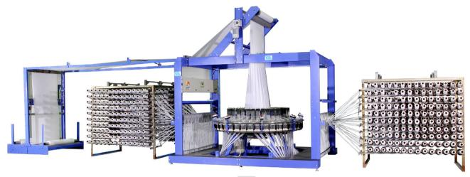
Asiastar-6M 小八梭圆织机折径范围 850~1250mm 最高转速可达 140 转/分钟。 此机型是公司专门为复合编织袋生产而设计的,适合行业:化工、水泥、建筑材料等 机器配置有内热式双剖装置,双收卷装置,是复合编织袋厂家的首选机型。
